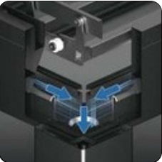
Wasserablauf über die Pfosten
