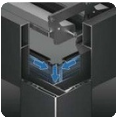
Wasser wird in den Pfosten geleitet
