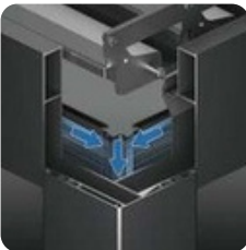
Wasser wird in den Pfosten geleitet
